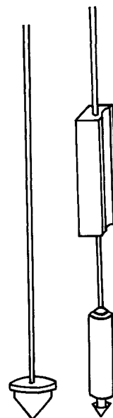
Afb. 29. schietlood, rechts met houten klosje
